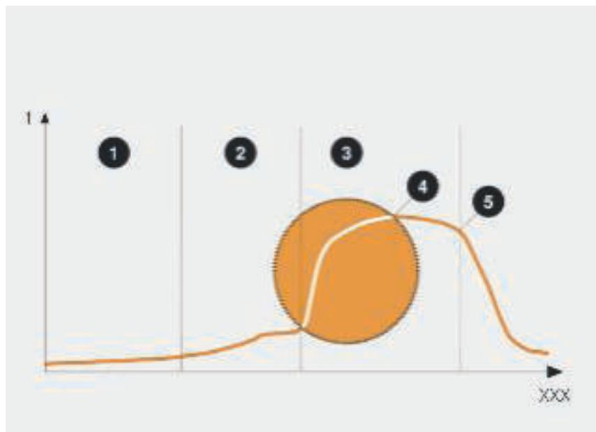
*Естественная причина пожара – Температурная кривая испытания на огнестойкость: 1=Воспламенение; 2=Этап установления пламени; 3=Общая вспышка; 4=Полное развитие пожара; 5=Начало этапа охлаждения*
