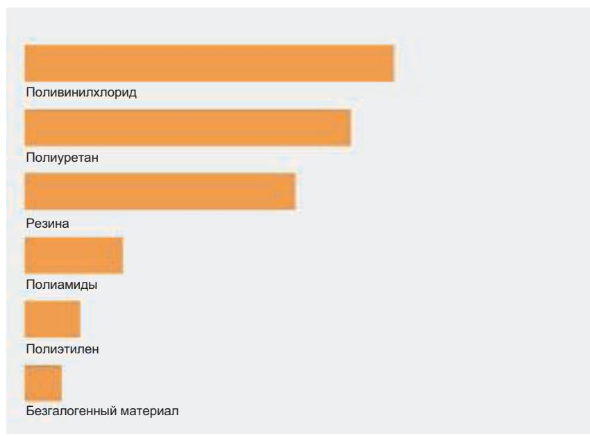
*Относительный объем дыма в минуту, образующийся при горении различных изоляционных материалов*
